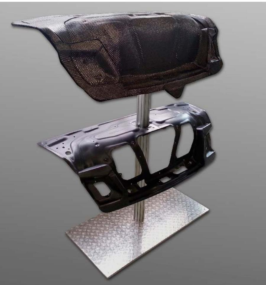
Eine Heckdeckelinnenstruktur, hergestellt im Hochdruck-RTM. Oben ist die Preform zu sehen, unten das final besäumte Bauteil.
