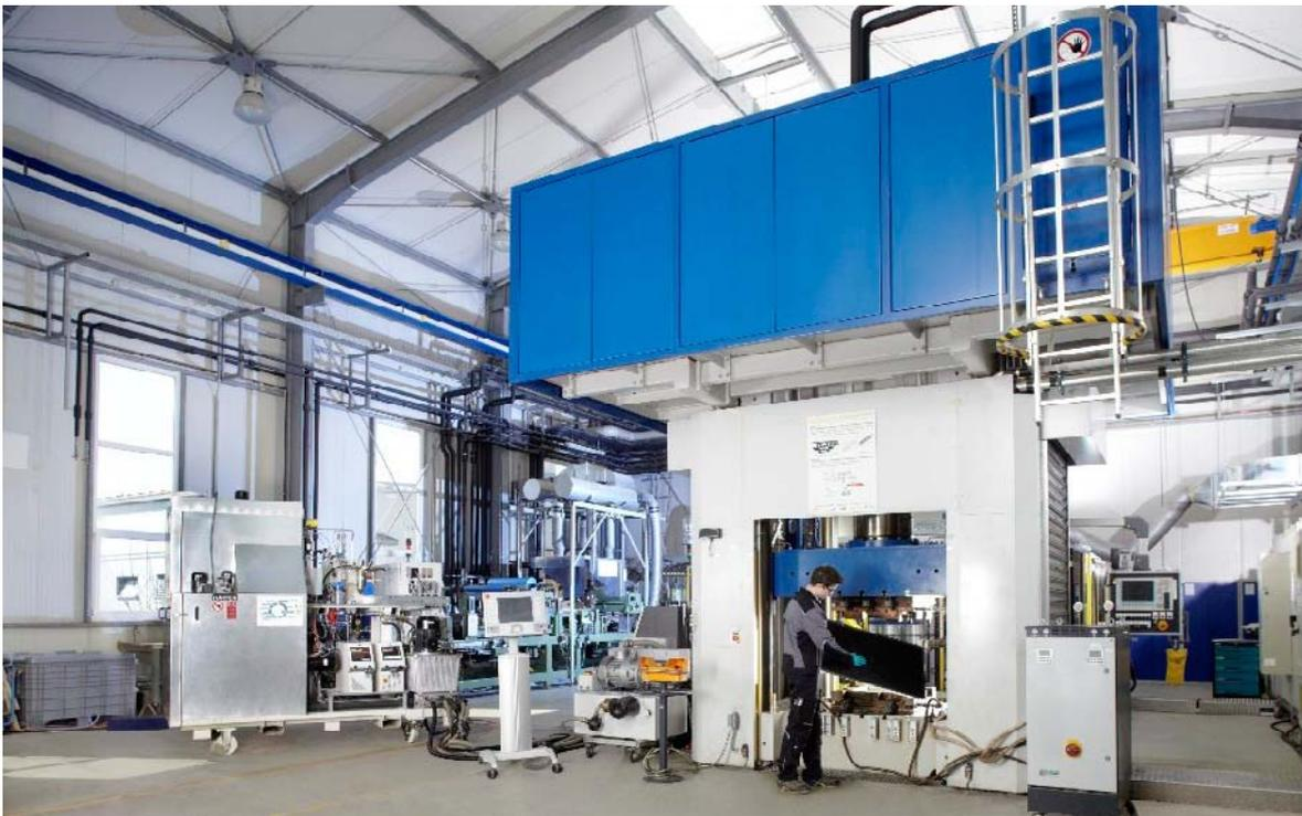
Die Hochdruck-RTM-Anlage inklusive hydraulischer Presse (rechts).
